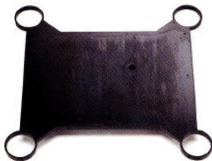
重量15kgにおよぶ真鍮製フローティングボード。本体シャーシと4個の大型サスペンションはこのボードを介して連結される。
