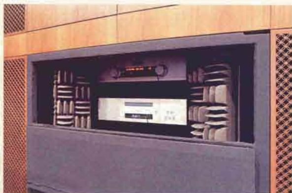
ソース機器ならびにプリアンプも、壁面に埋め込む仕様が採用された。上側の Mimesis 24 MEが、この膨大なシステムの司令塔である。
